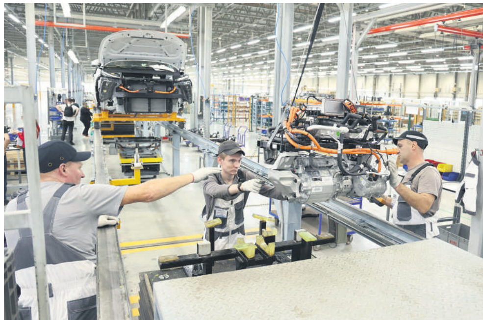
На линии сборки три этапа: сборка внутренних элементов салона, установка силовых элементов, установка колёс, фар
